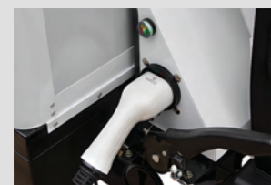
Typ2 Ladekabel eingesteckt
