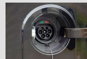
Ladebuchse in der Typ2-Ausführung
