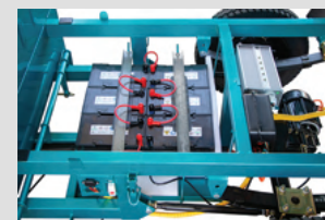
Batterieeinheit unter der Ladefläche
