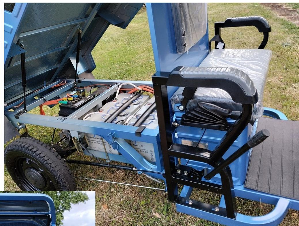
Handbremse für Hinterachse
