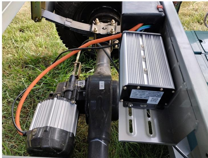
Hinterachse Untersetzungsgetriebee Mötör
