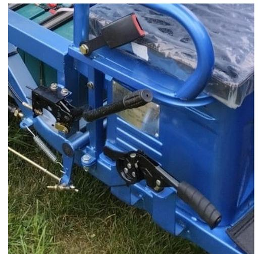
Handbremse für Hinterachse
