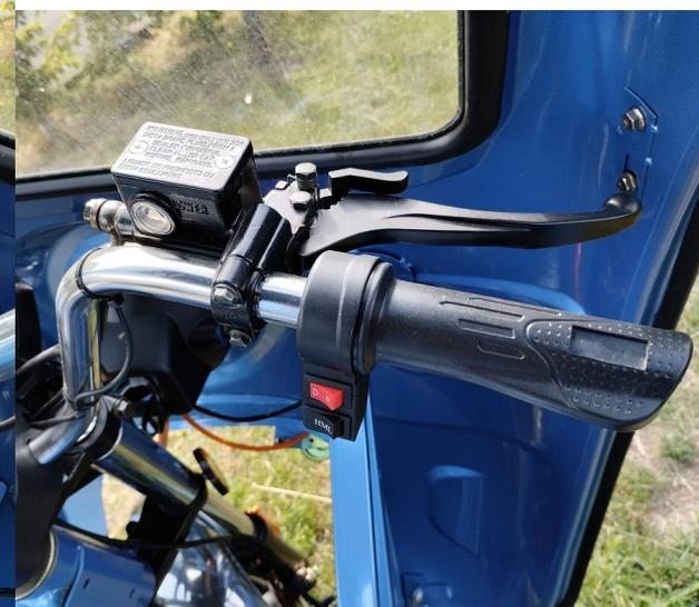
Lichtschalter Blinker Hupe Handyhalterung Tacho Ein/Aus Schalter. Vorderradbremse mit Hebelarretierung Vorwärts-Rückwärtsschalter
